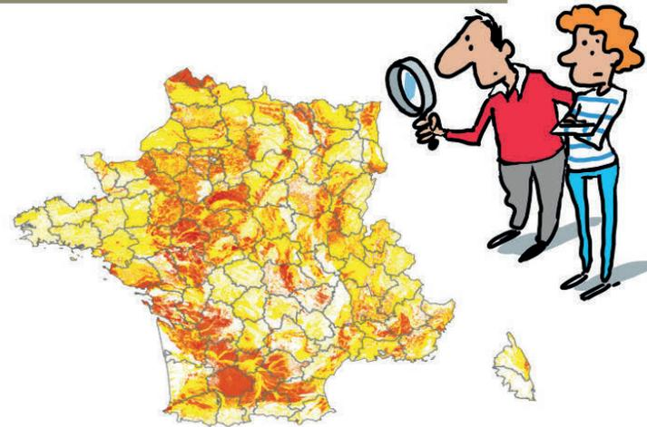
Exposition : Cette **cartographie** définit différentes zones en fonction de leur degré d'exposition au phénomène de mouvement de terrain différentiel consécutif à la sécheresse et à la réhydratation des sols argileux.
